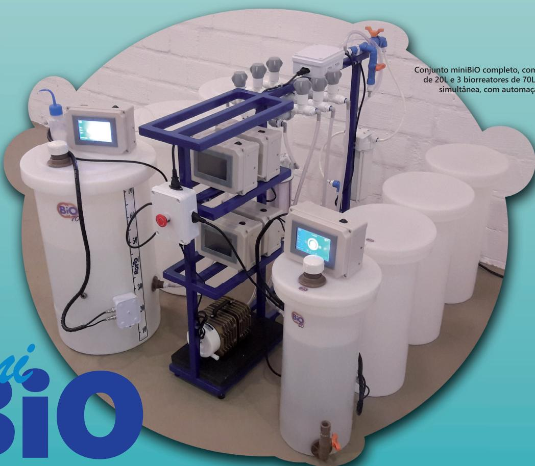
Conjunto miniBio completo, com 4 biorreatores de 20L e 3 biorreatores de 70L, para produção simultânea, com automação.
