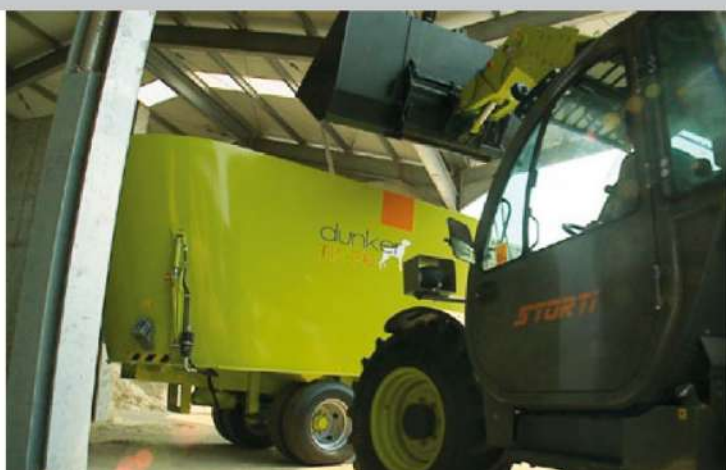
Piede di appoggio a comando oleodinamico collegato all'impianto idraulico del trattore Hydraulic foot connected to tractor hydraulics and controls Pie de apoyo hidráulico conectado directamente al tractor
