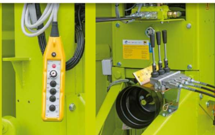
Due tipologie di comandi: elettrici (a sinistra) e meccanici flessibili al trattore (a destra)
