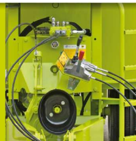
Cambio a due velocità di rotazione coclea, anche con leva in cabina trattore (optional)
