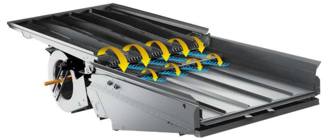
A linha TC mantém seu exclusivo sistema de bandejão, que tem um papel importantíssimo no processo de limpeza da máquina. O bandejão é responsável por realizar a estratificação do grão em que o material debulhado é agitado, e o grão, mais pesado, se deposita abaixo da camada de palha. Dessa maneira, o material é entregue à peneira em uma condição muito mais favorável de limpeza, o que otimiza todo o processo e diminui os índices de perdas.
