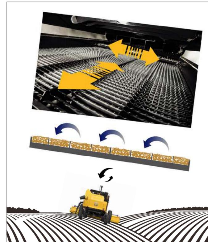
Assim, com o sistema de controle automático da velocidade do ventilador, o Opti-Fan™, em combinação com a SmartSieve, a linha TC é capaz de realizar a correção automática do relevo em qualquer sentido ou direção, sem que o operador tenha que se preocupar com isso.
