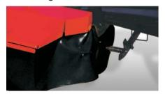
Seu dispositivo de segurança protege o equipamento contra impactos, entrando em ação automaticamente se, eventualmente a máquina chocar-se com algum tipo de obstáculo durante a operação. Quando este dispositivo é acionado a máquina articula-se para tráz evitando que o impacto cause danos a segadeira.
